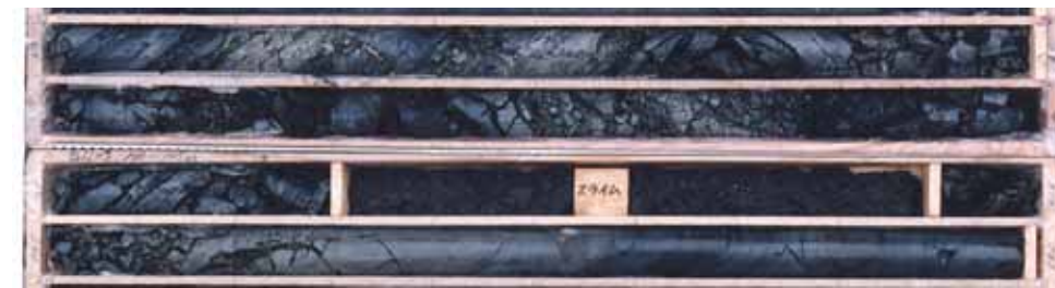
写真-3.5.4 珪質粘土岩中のせん断面顕在部 (B11-3 孔 98 ~ 101.2m 付近)
