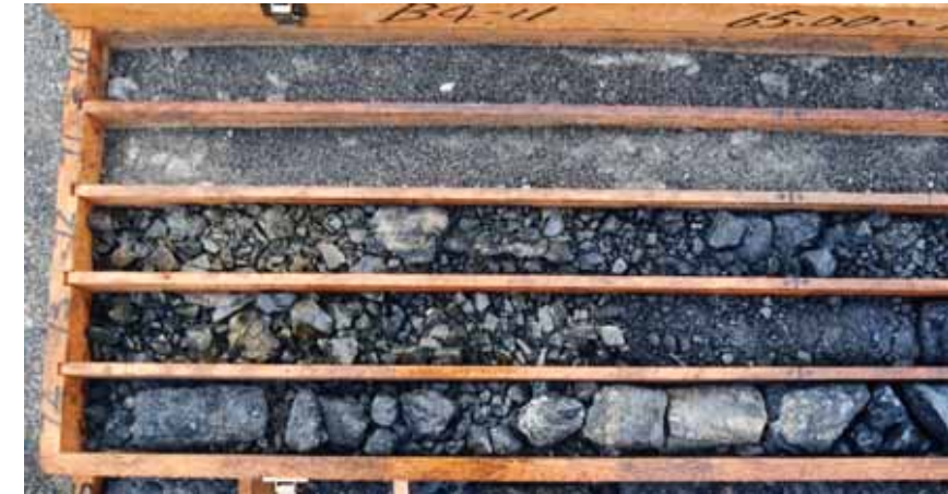
写真-3.5.8 珪質粘土岩中の劣化部 (B4-11 孔、70～75m付近) (全体にコア形状が悪く、スライム部分が多い。一部黒灰色粘土を伴う箇所は、T13R-1 坑に見られるような黒色泥岩挟在部の強劣化部と推定される。全体的には、潜在クラックが顕在化した CL 級相当の岩盤と見られる)
