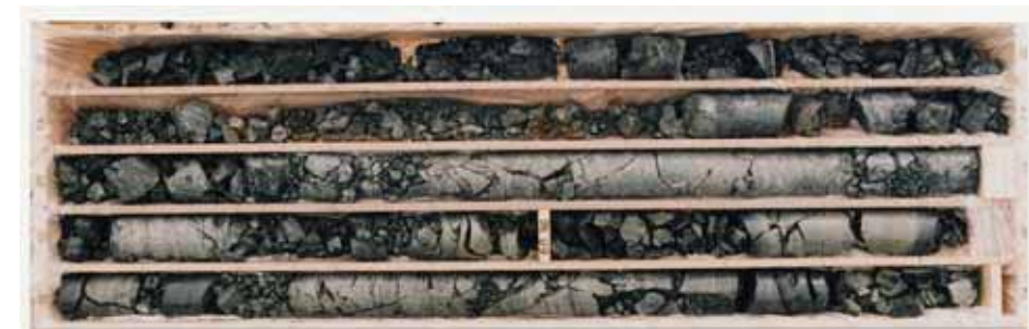
写真-3.5.5 珪質粘土岩中のせん断面顕在部 (コア採取率が悪い)
