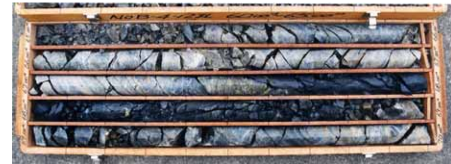
写真-3.5.9 黒色泥岩の劣化部 (B4-12 孔、65～70m付近) 緑灰色を呈する珪質粘土岩部に比べて割れ目の発達が著しく、岩片もやや軟質化している場合が多い。
