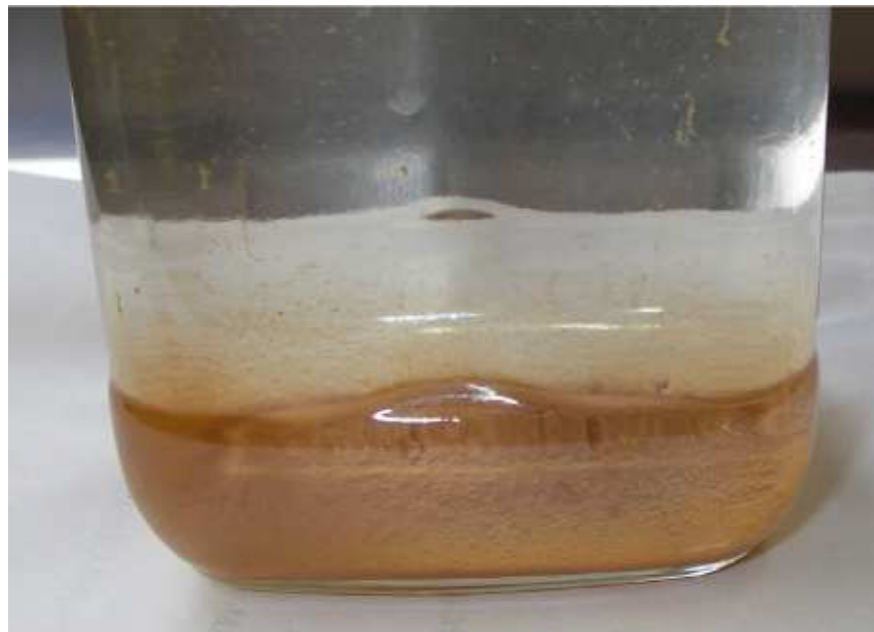
写真－ 2.3.2 漏水の沈殿物の例
