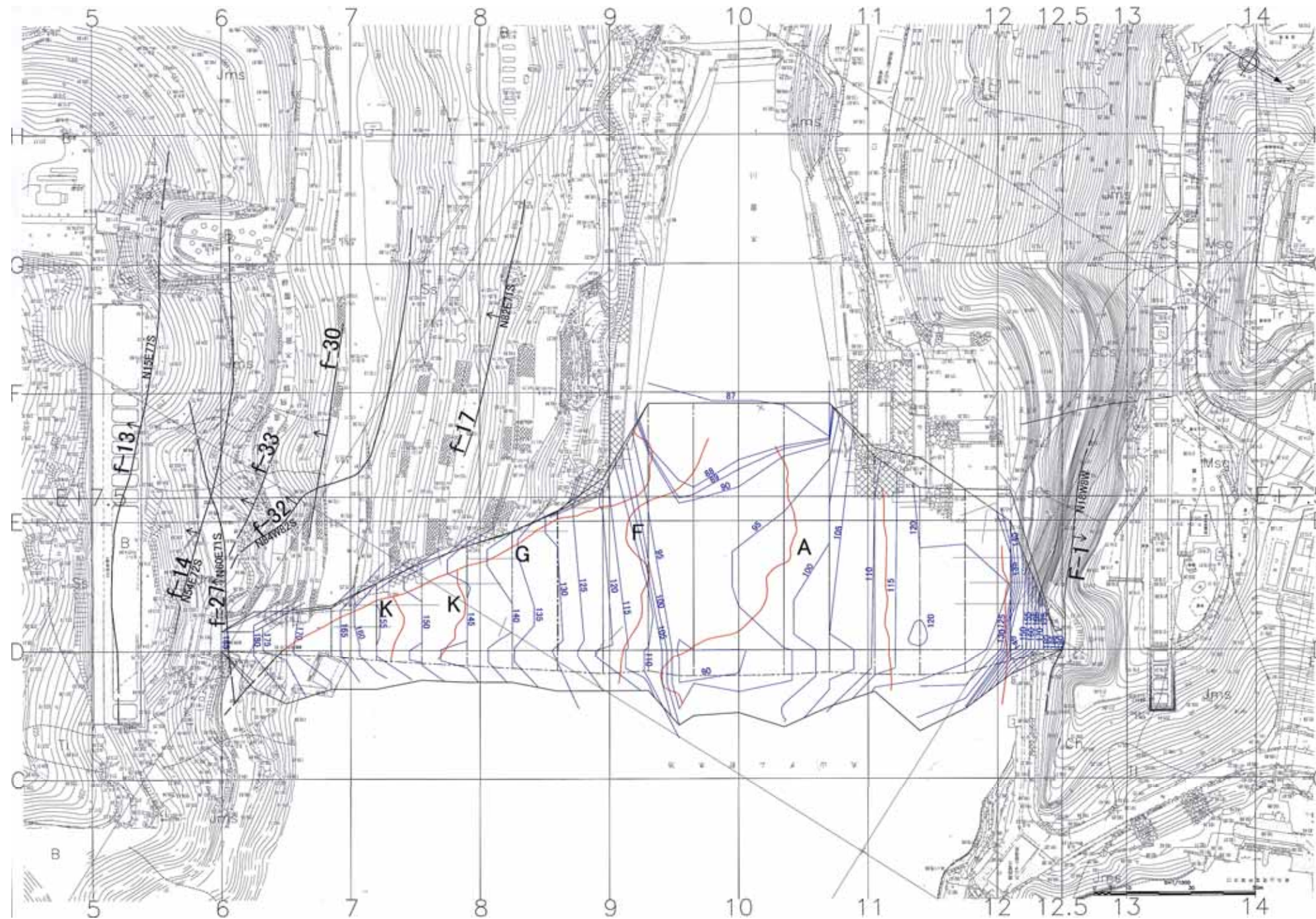
図 - 3.2.1 丸山ダム推定掘削平面図
